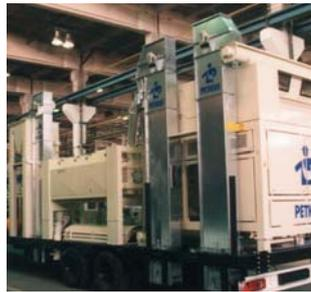
Becherewerke BE 100 installiert in mobilen und stationären Anlagen
