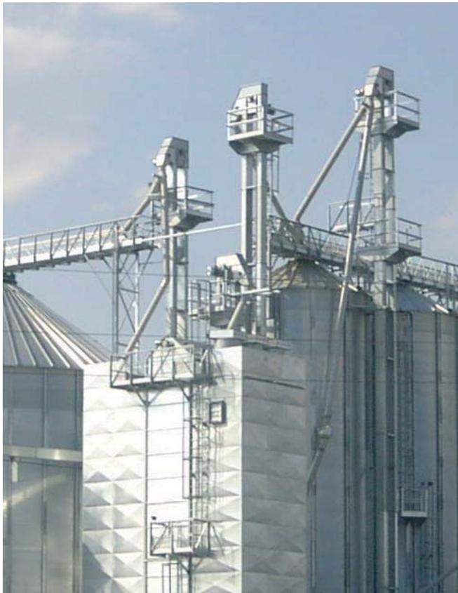
**PETKUS Becherelevatoren** sind für die senkrechte Förderung von rieselfähigen Schüttgütern aus dem industriellen und landwirtschaftlichen Bereich wie z.B. Granulate, Getreide, Ölsaaten, Hülsenfrüchten, sowie für den Transport pulverförmiger Produkte geeignet.
