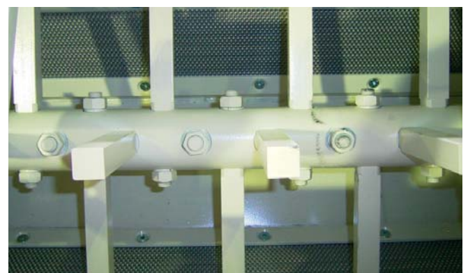
Entgrannertrug mit Zellenauskleidung und quadratischen Schlagstiften
