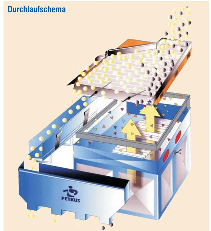
**PETKUS Gewichtsausleser** sortieren nach dem spezifischem Gewicht und werden überall dort eingesetzt wo Produkte mit unterschiedlichen Gewichten getrennt werden müssen.
