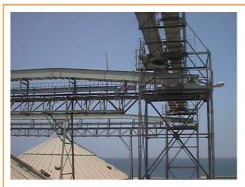
**PETKUS Trogkettenförderer** sind für die horizontale und leicht ansteigende Förderung von körnigen und pulverförmigen Produkten geeignet. Die optimale Förderung kann für jedes Medium durch Veränderung der Kettengeschwindigkeit erreicht werden.
