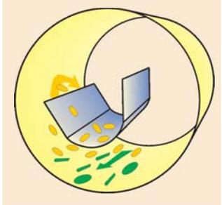
**PETKUS Zellausleser** sind Aufbereitungsmaschinen, die körnige Produkte nach der Kornlänge sortieren und trennen und vorrangig bei der Aufbereitung von Saatgut und in der Mühlenindustrie eingesetzt werden.
