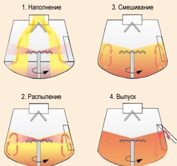
**Протравливатели порционного действия СТ 50** работают по роторно-статорному принципу. Специальное исполнение конструкции ротора и статора обеспечивает полное и равномерное покрытие семян.
